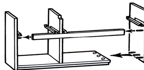
5. Lassen Sie die Rückwände in die Führungsnuten gleiten. Stecken Sie von oben die Deckplatte auf und ziehen Sie innen die Verbinder zur Deckplatte hin fest.
