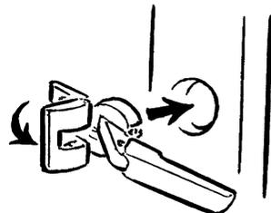
7. Die Türen werden „eingehängt“, indem Scharniere und Grundplatten von oben nach unten nacheinander zusammengedrückt werden.
