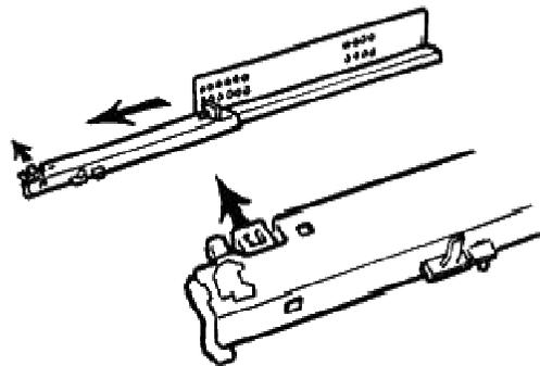
11. Dann lassen Sie die Lade ganz auf die Schienen herab und befestigen die Lade, indem Sie den kleinen Schieber auf der Unterseite der beiden Schienen nach außen drücken.
