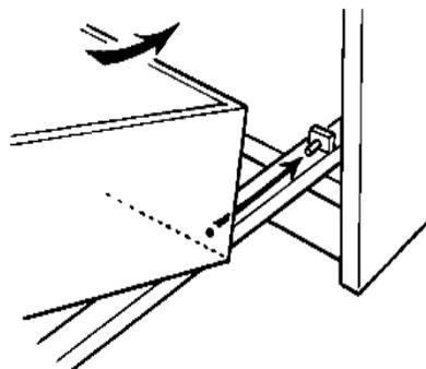
12. Jetzt können Sie die Ladenfronten anschrauben. Nehmen Sie dazu bei den beiden äußeren Seiten der Ladenfronten die innersten Bohrungen, bei den Ladenfrontseiten, die zur Mitte des Möbels hin liegen, die 2. Bohrung von innen.
