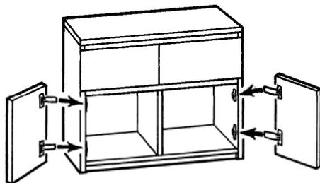
Die Abbildung zeigt Ihnen, wo Sie drücken müssen, damit der Scharnierverschluss einschnappt. Ein *deutlich* hörbares Klicken zeigt an, dass die Teile richtig eingerastet sind.
