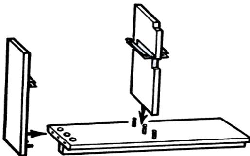
4. Stecken Sie die Mittelblende (mit den Verbindern nach innen weisend) zuerst in die schon eingesteckte Seitenwand ein und ziehen Sie dort den Verbindner fest. Dann die zweite Seitenwand auf den Sockel sowie in die Mittelblende stecken und die Verbinder am Sockel und der Mittelblende festziehen.
